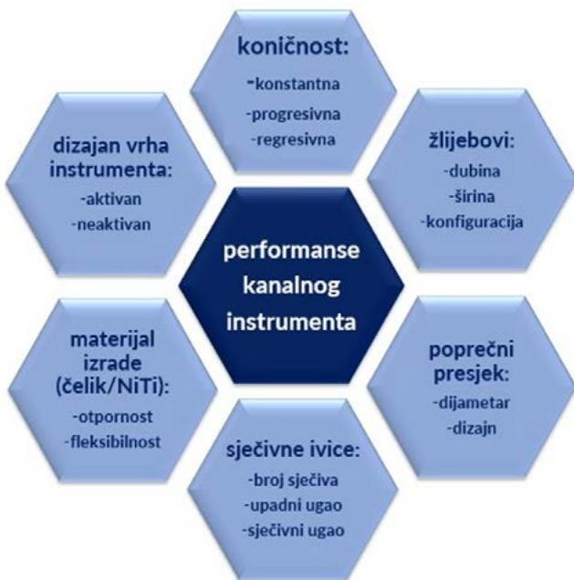
Slika 1. Komponente kanalnih instrumenata koje utiču na performanse tokom instrumentacije
